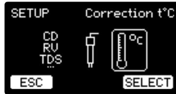
Utiliser les flèches **horizontales** pour sélectionner l'icône **Correction en t°C** puis appuyer sous l'icône **SELECT** pour valider votre choix
