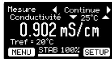
Vous n'avez pas connecté de sonde de température au conductimètre. Mesurez la température de l'échantillon et entrez cette température avec les touches (résolution : 1°C).
