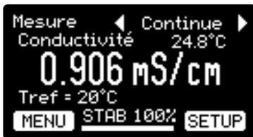
Vous avez connecté une sonde de température au conductimètre. La mesure de la température est affichée avec une résolution de 0,1°C.
