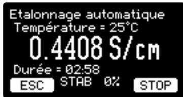
Pour forcer l'étalonnage appuyer sur **STOP**
