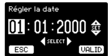
Appuyer sur la flèche **gauche** jusqu'à faire apparaître l'icône **Régler la date**
