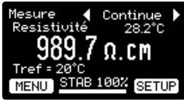
Pour entrer dans le menu de configuration appuyer sous l'icône **SETUP**
