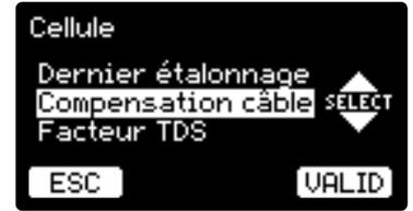
Utiliser les flèches **verticales** pour sélectionner l'option **Compensation câble** puis appuyer sous l'icône **VALID** pour valider votre choix
