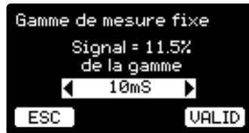
Utiliser les flèches **horizontales** pour sélectionner la gamme adaptée grâce à l'indicateur puis appuyer sous l'icône **VALID** pour valider votre choix
