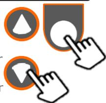
Utiliser les flèches **verticales** pour sélectionner le paramètre à régler et les flèches **horizontales** pour régler la valeur.
