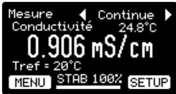
Pour accéder au menu **SETUP** appuyer sous l'icône **SETUP**
