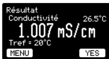
Appuyer sous l'icône **YES** pour lancer une nouvelle mesure.
