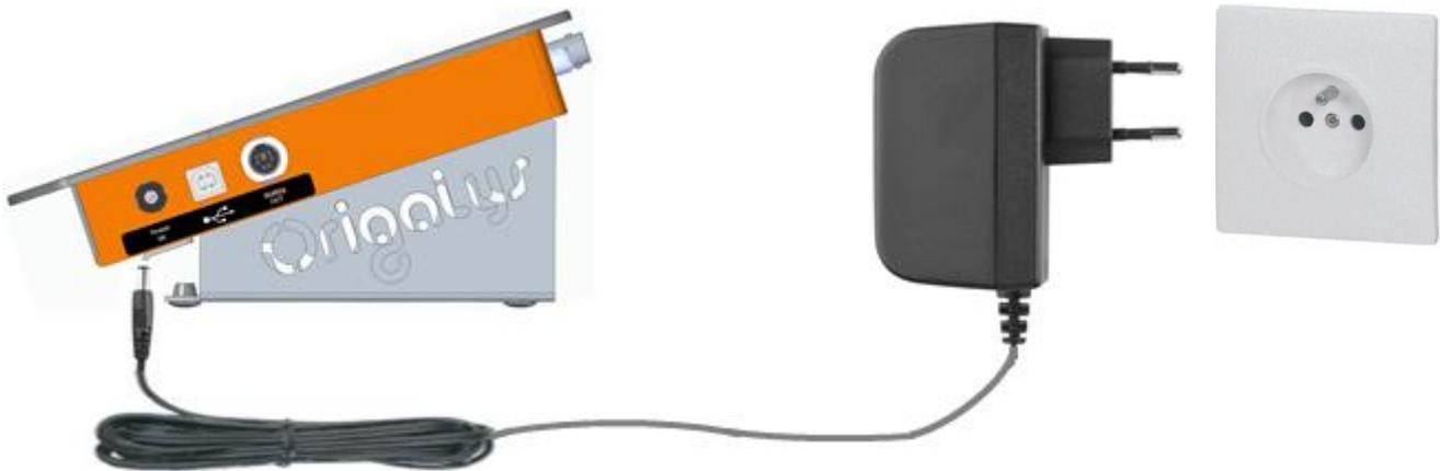
Il est également possible d'alimenter le conductimètre via la connexion USB. Dans ce cas, déconnecter l'adaptateur secteur du réseau d'alimentation et de la prise **Power IN** du conductimètre.
