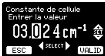
Utiliser les flèches **horizontales** pour sélectionner le digit à modifier, et les flèches **verticales** pour régler la valeur puis appuyer sous l'icone **VALID** pour valider votre choix
