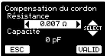
Utiliser les flèches **verticales** pour sélectionner l'option à régler et les flèches **horizontales** pour régler sa valeur.
