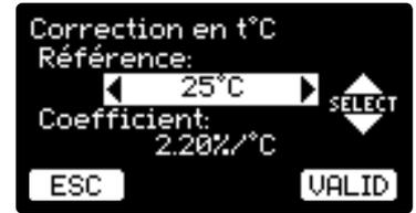
Utiliser les flèches **verticales** pour sélectionner l'option à régler et les flèches **horizontales** pour régler sa valeur.
