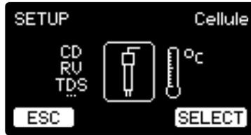
Utiliser les flèches **horizontales** pour sélectionner l'icône **Cellule** puis appuyer sous l'icône **SELECT** pour valider votre choix
