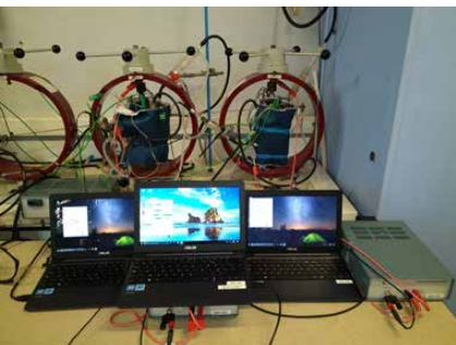
► Dispositif de propagation de fissure sur éprouvette CT
