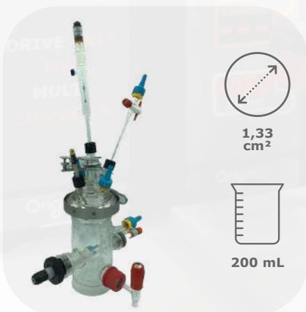
Cette cellule de corrosion thermostatée (Flow Cell) est parfaite pour la corrosion galvanique sur des surfaces inférieures  $2 \text{ cm}^2$  et pour des échantillons disque.
