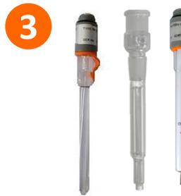
**3** Une électrode de **référence** Ag/AgCl + son allonge + une **contre électrode** à fil de platine
