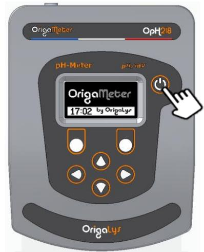
Appuyer sur une des touches du clavier, l'écran de mesure de pH / mV en mode continu apparaît :
