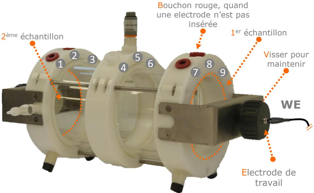
**La parfaite cellule pour la corrosion galvanique**
